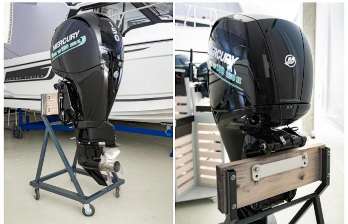
Motor Mercury GPM DF150 XL an Lager mit Katalisator für Bodenseezulassung.
